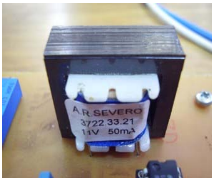
Figura 1. Transformador de Medição.
